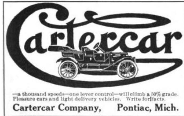
Cartercar desarrolló un acertado sistema de transmisión por fricción. El sistema de transmisión friction-drive permitía engranar cualquier posición de marcha. Debido a que su transmisión por fricción permitía seleccionar cualquier relación de transmisión en lugar de tener posiciones de marcha fijas, el Cartercar se publicitó como "El coche de las mil velocidades". Otro anuncio proclamaba: "Es difícil mejorar un Cartercar".
