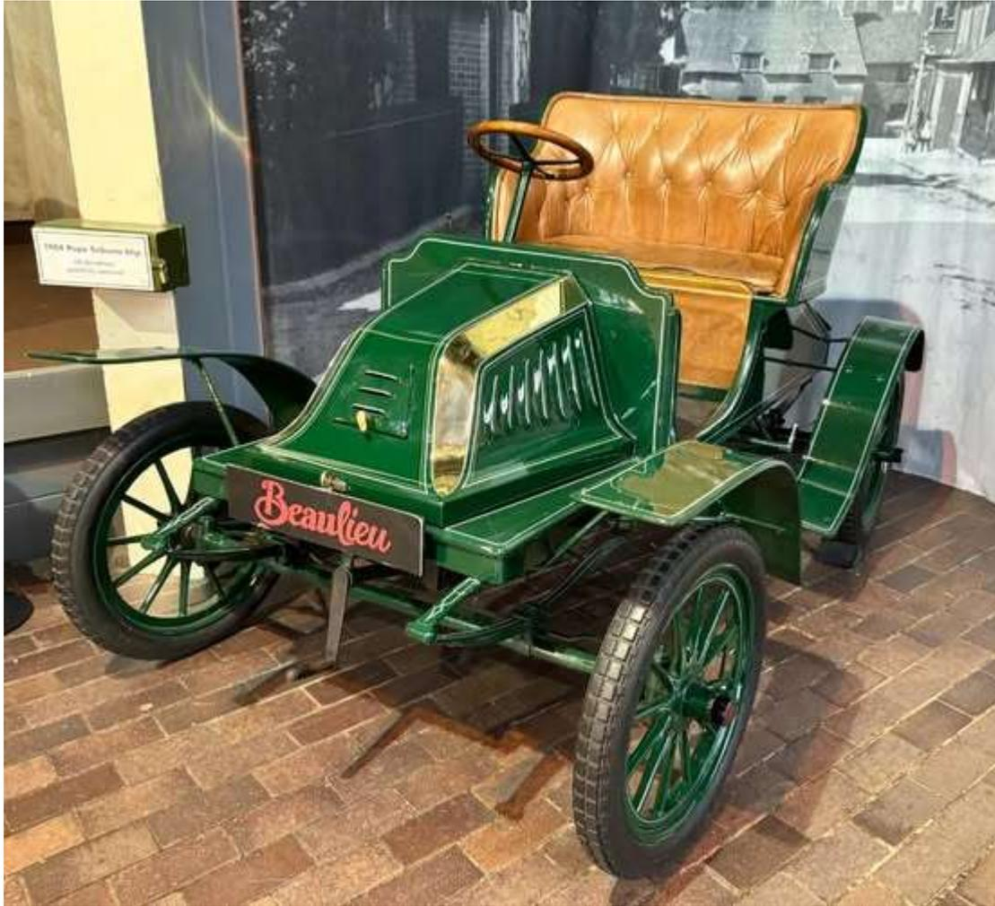
1904 Pope-Tribune 6HP Runabout con motor monocilíndrico de 798cc. y transmisión cardan. Alcanzaba los 40 km/h y fue distribuido en Gran Bretaña por la Agencia de Motores y Ciclos del Servicio Civil de High Holborn, Londres.
